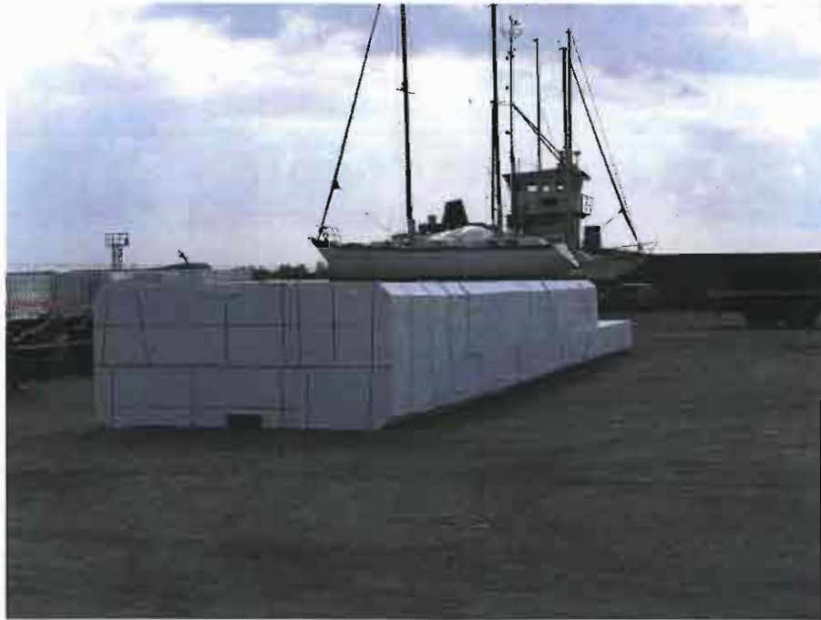
Op maat gesneden polystyreen blokken
